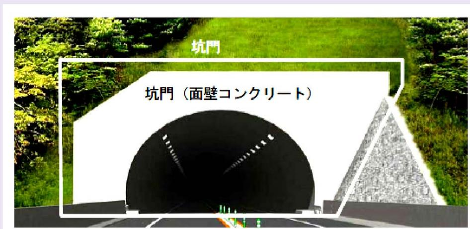
図-4.2 点検対象箇所（トンネル坑口部）
