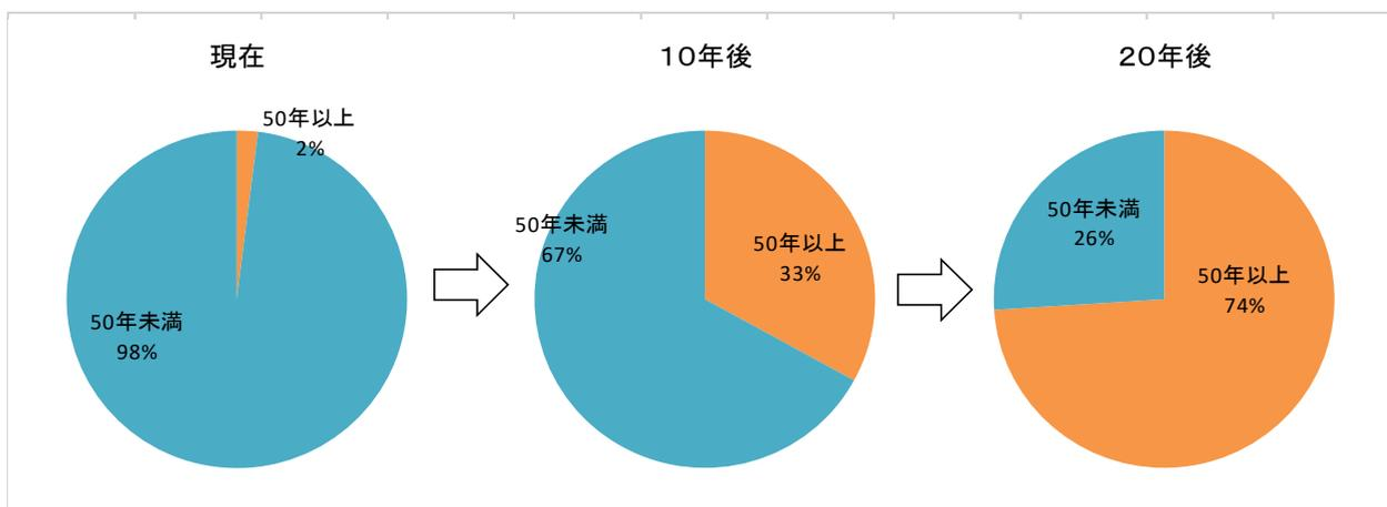
図1-3 建設後50年以上経過した橋の割合（跨道橋、橋長15m以上）
