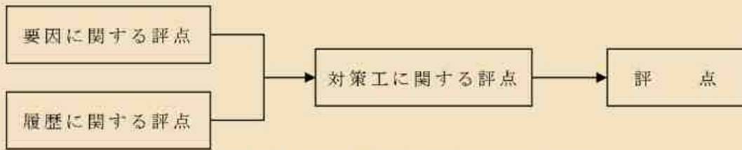
図 7.5-29 安定度評点の考え方（地すべり）
