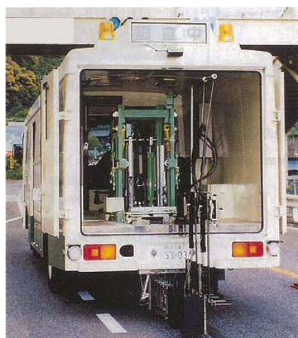
<写真 4.1-1>車載型 FWD の外観例
