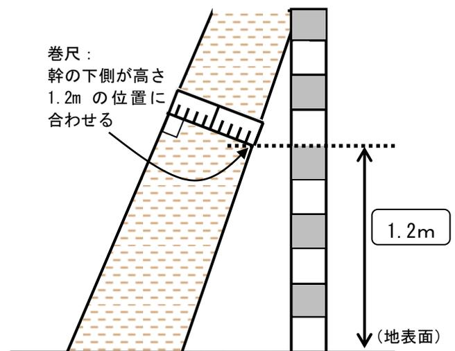
図2 高木が傾いている場合の計測方法
