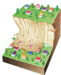
急傾斜地の崩壊
