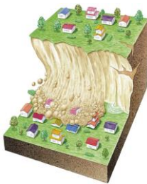
急傾斜地の崩壊
