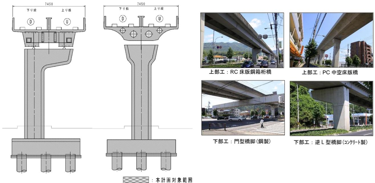
図-1.2.1 高架橋標準断面図(一般部)
