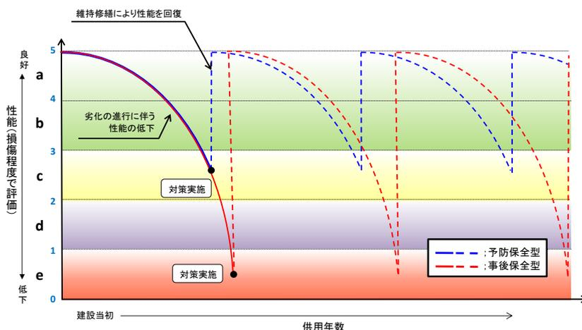
図-3.6.1 損傷程度の劣化曲線 (イメージ)
