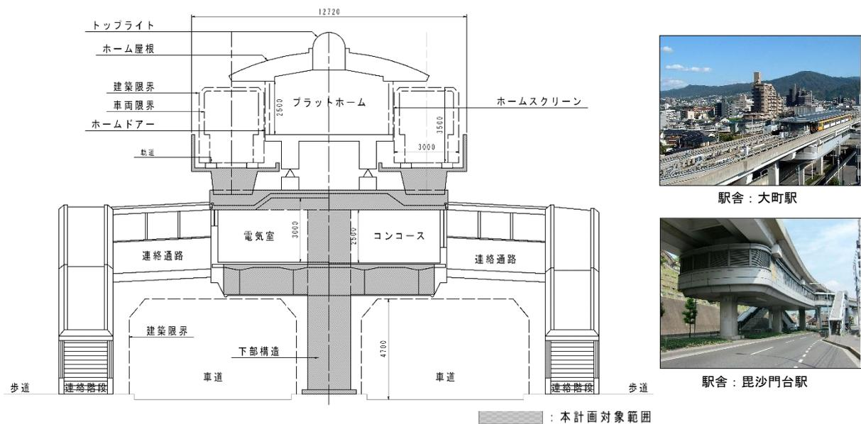
図-1.2.2 高架橋標準断面図(駅舎部)
