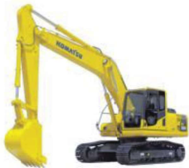
油圧ショベル (バックホー)
