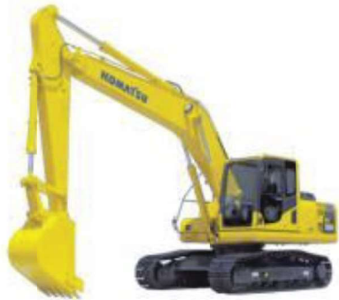
油圧ショベル (バックホー)
