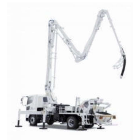
コンクリート ポンプ車
