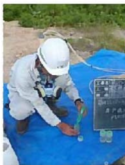
写真-1 孔内水位の測定状況
