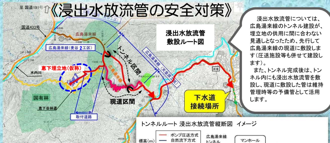
浸出水放流管については、広島湯来線のトンネル建設が、埋立地の供用に間に合わない見通しとなったため、先行して広島湯来線の現道に敷設します(圧送施設等も併せて建設します)。また、トンネル完成後は、トンネル内にも浸出水放流管を敷設し、現道に敷設した管は維持管理時等の予備管として活用します。
