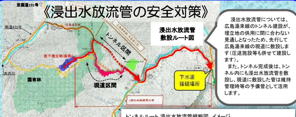
浸出水放流管については、広島湯来線のトンネル建設が、埋立地の供用に間に合わない見通しとなったため、先行して広島湯来線の現道に敷設します(圧送施設等も併せて建設します)。
