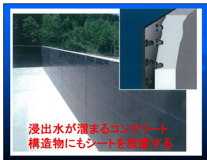
図-2 浸出水調整池の遮水工 (イメージ)
