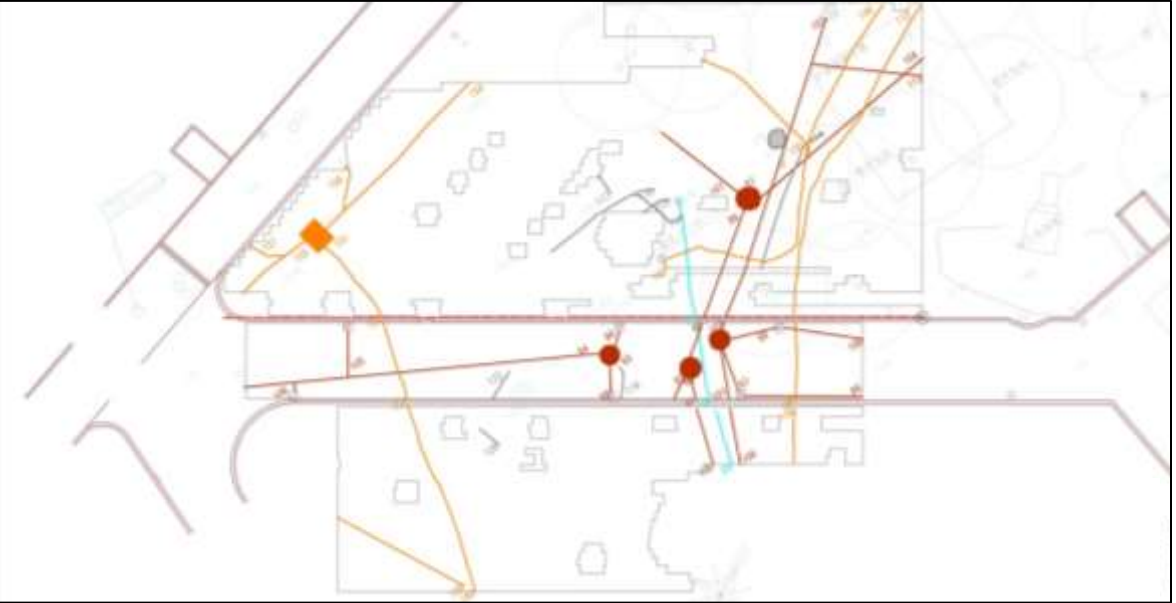
図2 水道・下水道・電力などの埋設管と思われる反射信号が検知された場所（深さ 0.3m～1.5m 程度）
