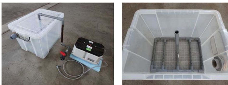
図 4 送気式ばっ気装置(実証試験器)
