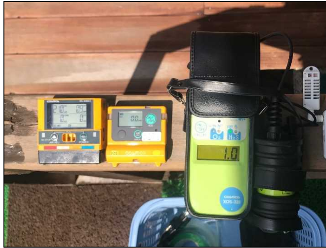
図 24 拡散式及び吸引式硫化水素計
