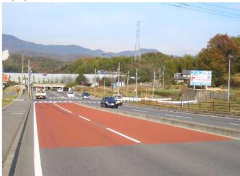
車道の舗装の色を変え、速度抑制や注意
