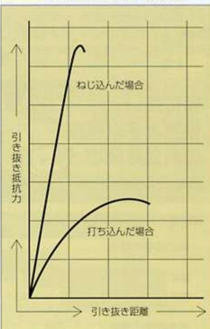
上表は、ラワンに木ネジ(2.7×20)を打ち込んで取り付けた場合と、ねじ込んで取り付けた場合との引き抜き抵抗力を調べたものです。打ち込んで取り付けた場合は小さな引き抜き力でズレズレと抜けていきますが、ねじ込んで取り付けた場合には限界点までは頑張って抵抗していることが分かります。
