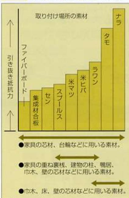
上表は、一般によく使用されている建築材料に、木ネジ(2.7×16)をドライバーでねじ込み、その引き抜き抵抗力を調べて比較表にしたもので
