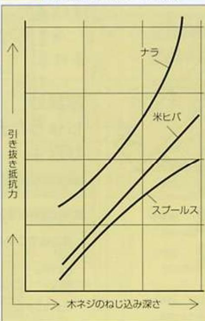
上表は、木ネジの長さ(すなわち、ねじ込み深さ)を変えることにより、引き抜き抵抗力がどう変化するか調べたものです。取り付け材の如何にかかわらず、木ネジ長さが増加すると引き抜き抵抗力も増すことが分かります。
