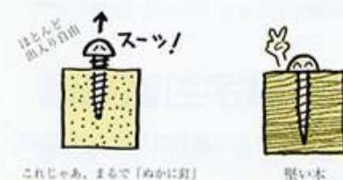
**参考資料1** 取り付け場所の素材の違いによる引き抜き抵抗力 比較表
