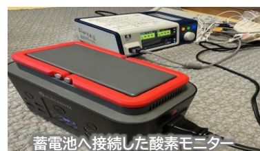
蓄電池へ接続した酸素モニター
