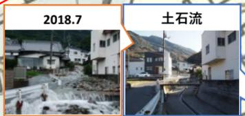
原山から土石流が発生、押し出された土砂や岩石、倒木が川を塞いだ為、濁流が瀬野川に流れず、町内に流れ込んだことが、浸水被害の大きな要因となった。
