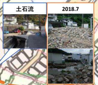
土石流で押し出された土砂や石で川を塞いだ為、濁流が町内に流れ込んだことが、浸水被害の大きな要因となった。
