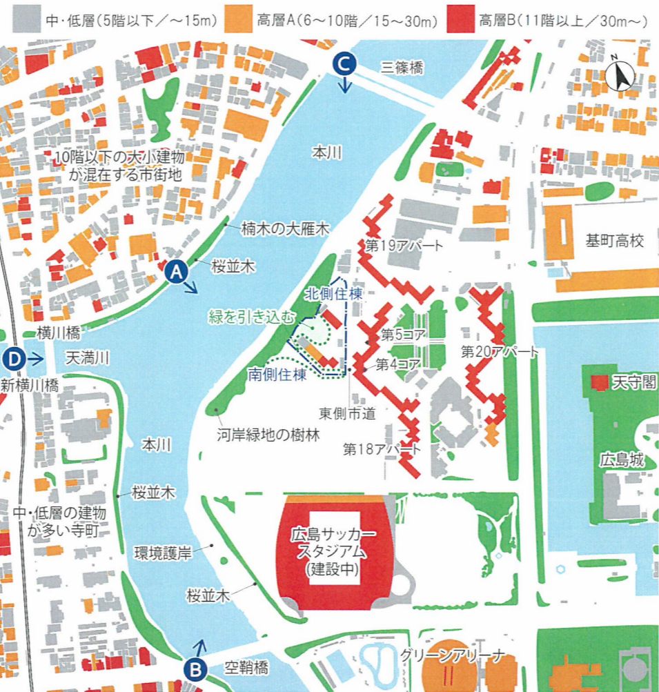
図5 基町団地周辺の建物ボリューム・緑の分布と計画敷地の配置イメージ
