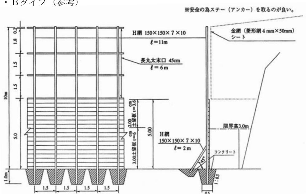
[別図] 支柱詳細図 (防護柵B型)
