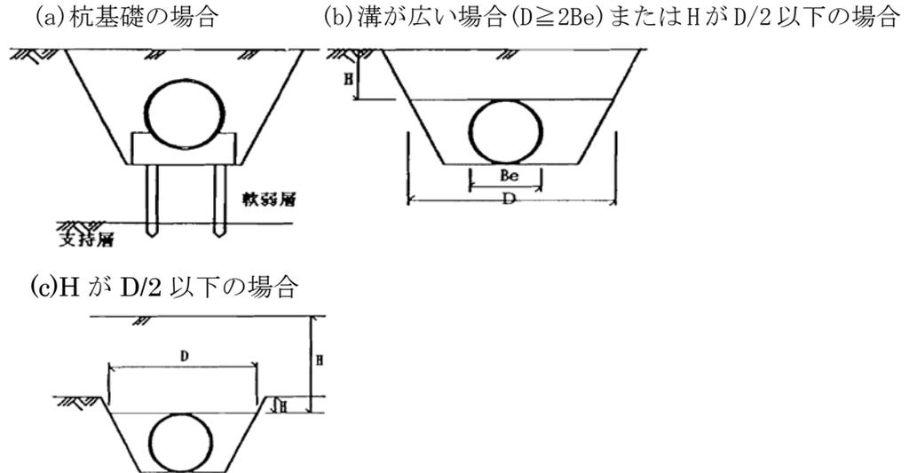
プレロードを行い長期間放置した盛土を掘削し管を設置する場合は、溝型と考える。
