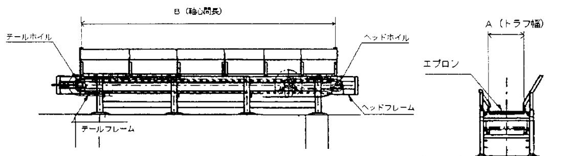
参考図-1 (レーク形除塵設備)
