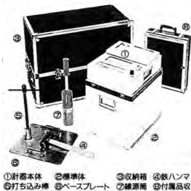
図-4 計器の構成例（透過型）
