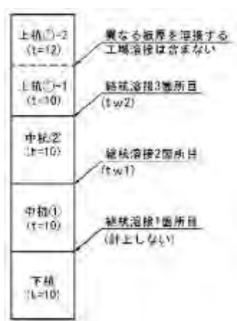
図 5-1 継杭溶接箇所 (参考図)
