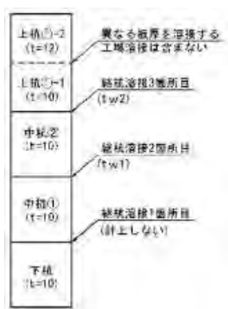
図 5-1 継杭溶接箇所（参考図）
