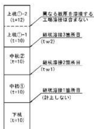
図 5-1 継杭溶接箇所 (参考図)
