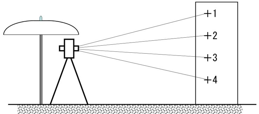
鉛直角測定の測点の配置図
