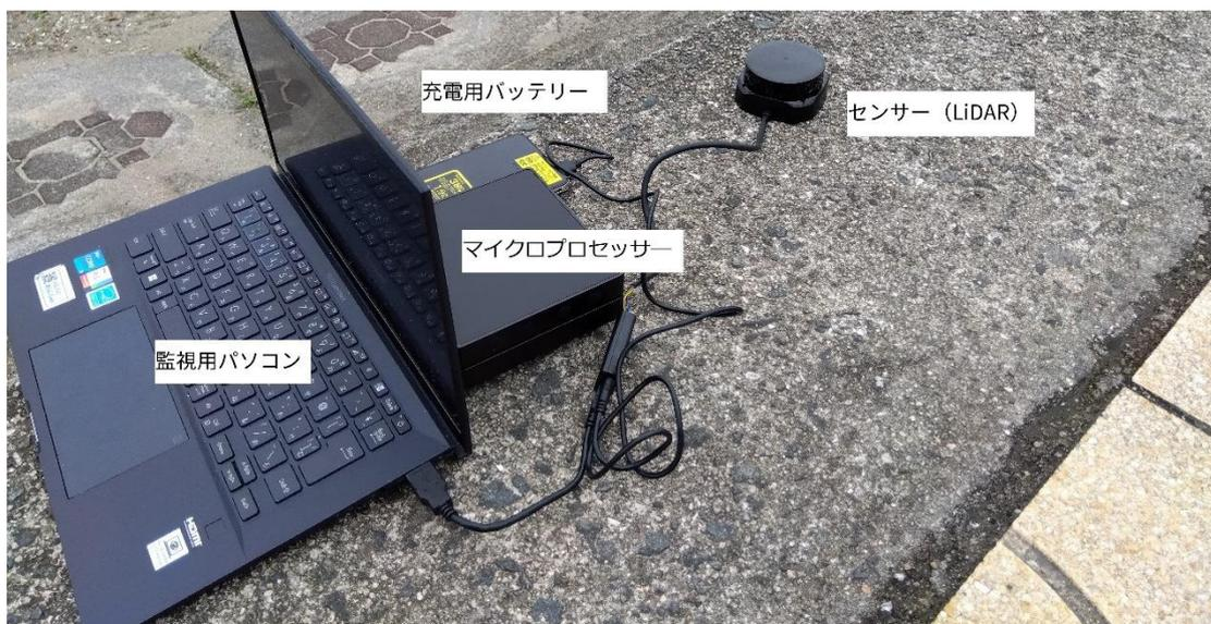
図5 漂流物検知システムの概要
