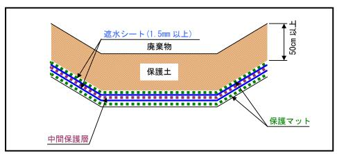
図 2-2-6 二重遮水シート工概念図
