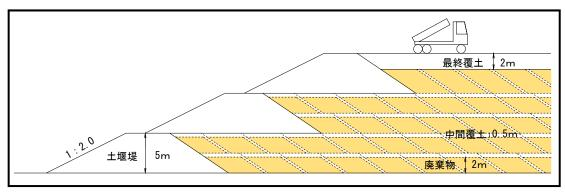
図 2-2-7 埋立工法イメージ図
