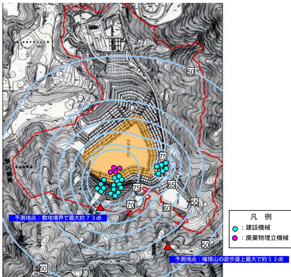
図11 建設作業騒音予測結果【工事の実施】
