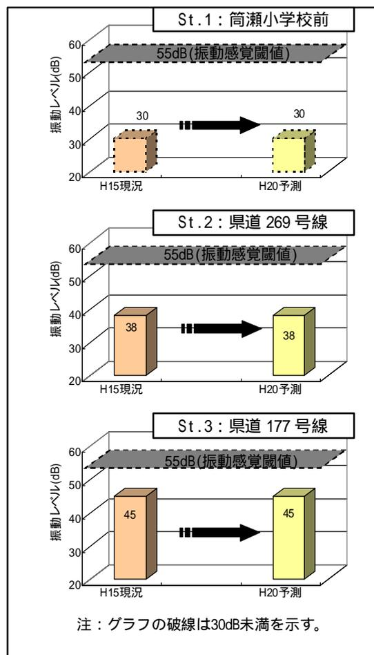
図16 道路交通振動予測結果【工事の実施】
