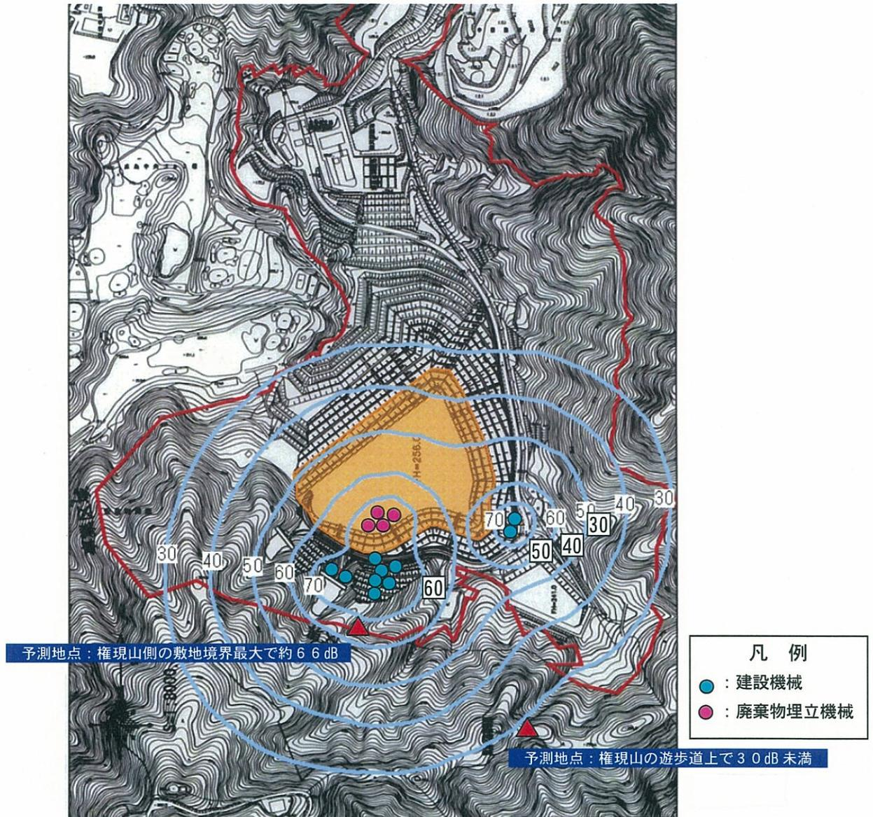
図 17 建設作業振動予測結果【工事の実施】
