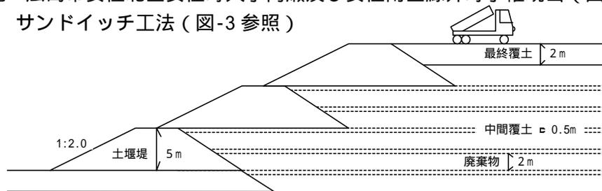
図-3 埋立方法 (サンドイッチ工法)
