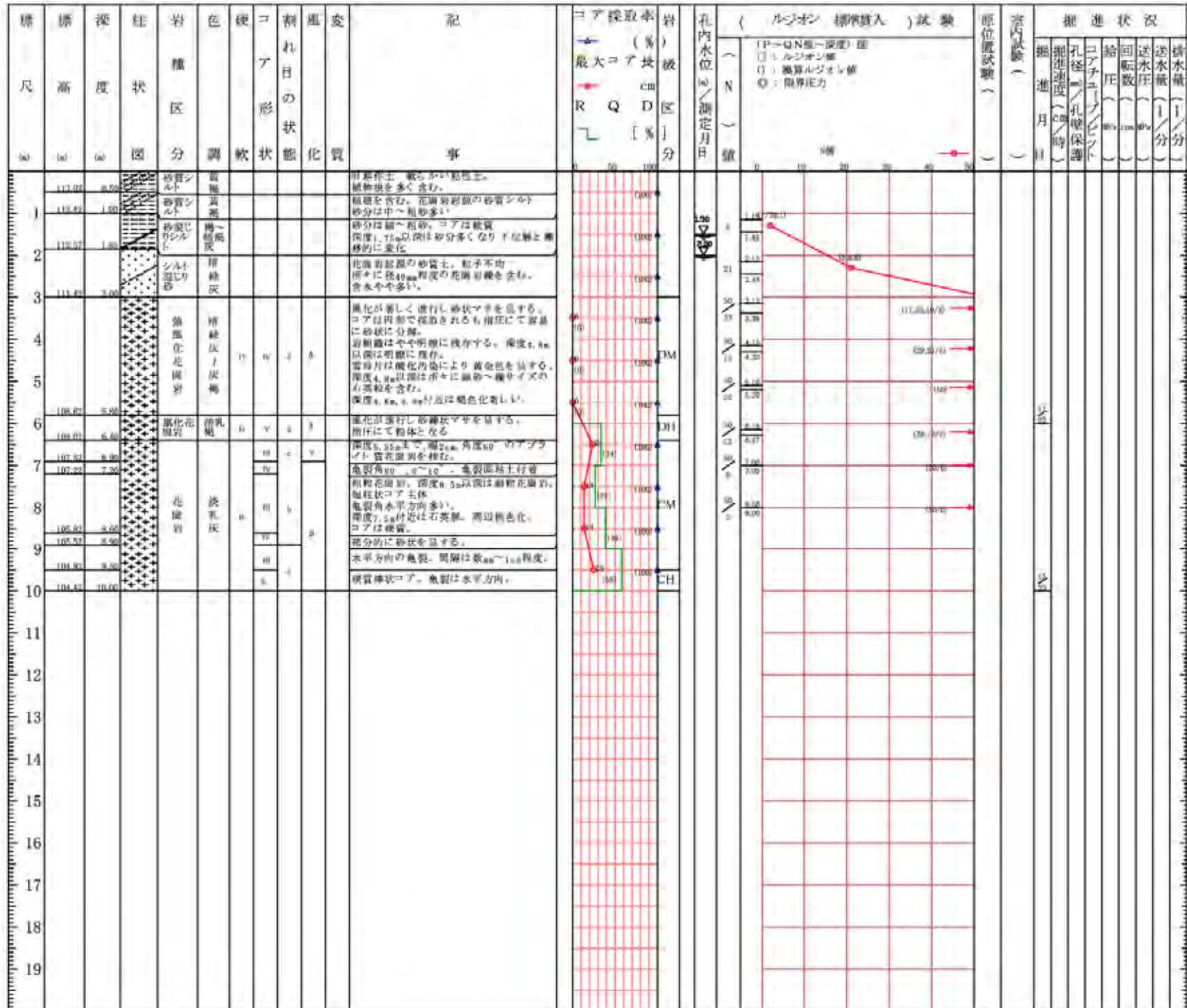
図 2-6-11 ボーリング柱状図 (No.11)
