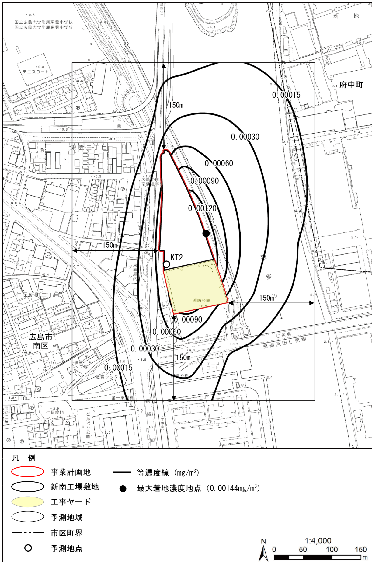
図 7.1-13(2) 建設機械の稼働に伴う浮遊粒子状物質寄与濃度予測結果
