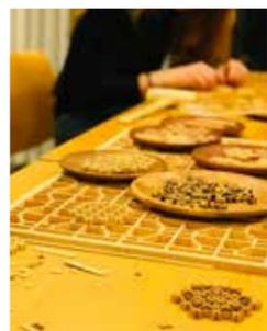
La technique kumiko est une technique traditionnelle consistant à assembler des morceaux de bois sans utiliser de clous. Ces bouts de bois sont minutieusement taillés de telle sorte qu'il soit possible de les assembler parfaitement entre eux. Le plus ancien bâtiment japonais fabriqué avec la technique kumiko est le temple Hôryû-ji qui date de la période d'Asuka (du milieu du VIe siècle jusqu'à l'an 710).
