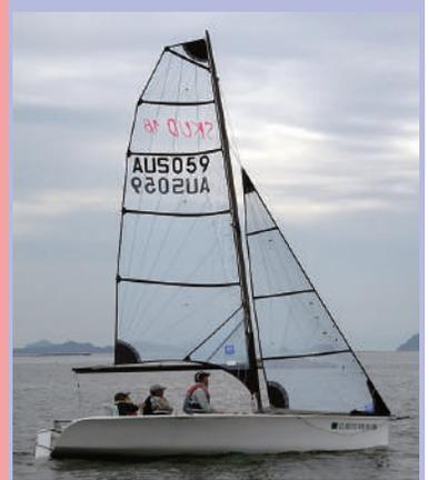
パラリンピックの競技種目。小型モーターの補助装置を備え、スピードのあるダイナミックなセーリング艇です。
