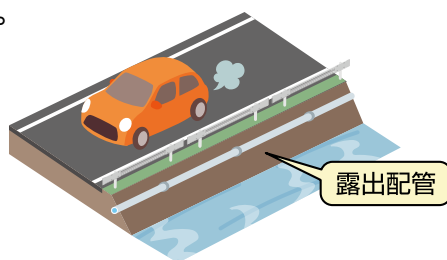
露出配管による整備イメージ
