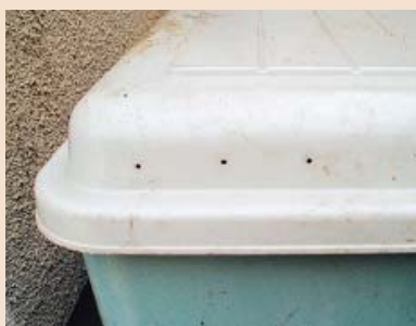
⑧ふたに空気穴を開ける。 (直径2mm程度の穴)
